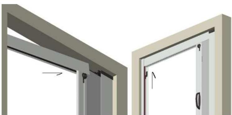
10) Τοποθετήστε τον πάνω οδηγό και στερεώστε τον ανεβάζοντας το τερματικό που βρίσκεται περασμένο μέσα στο αντίκρισμα.
