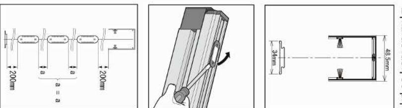
④ Τοποθετήστε προσωρινά το πώρο στηρίγματα 200mm κάτω από το έλαστο πίνακα οδηγού, αφαιρέστε την τοίχου που βρίσκεται στο πάνω μέρος. Ακολουθήστε την ίδια διδικτοστιά, τοποθετήστε το δυστρέπτη στηρίγματα 200mm πάνω από την ταύτια κύλινδρο, δίπλα στην διπλανή εκόλη. Ισορρόπεστε τα υπόλοιπα στηριγμάτα στην ενδιάμεση αποστάση.
